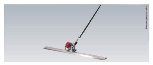
Règle oscillante légère thermique, plusieurs profils aluminium interchangeables de 2m, 2,5m et 3m. Equipé d'un moteur HONDA GX25, 1 cv, facile d'utilisation et d'entretien, le moteur se détache pour changer de profils. Le manche d'1,80m s'emboite et se déboite facilement, pour aider au transport.
